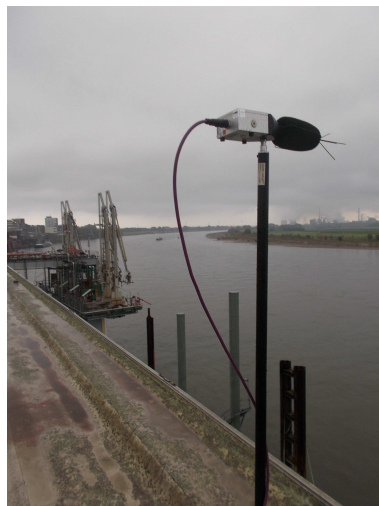
Abbildung 3.1: Foto Messmikrofon auf dem Gebäudedach vom Hochwasserpumpwerk
