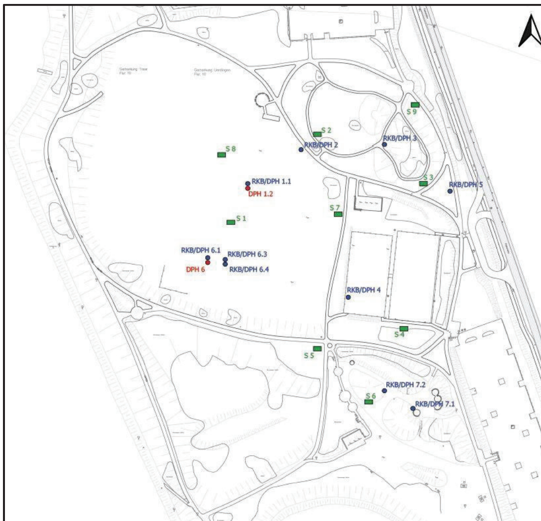
Abbildung 3: Lage Baggerschürfe, Rammkernbohrungen und Sondierungen (S 1 - 9: Baggerschürfe; RKB 1 -7: Rammkernbohrungen; DPH 1 – 7: Schwere Rammsondierungen)
